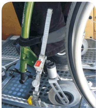
Anclaje colocado en el raíl de un autobús o vehículo adaptado, sujetando la rueda delantera de la silla de ruedas.
