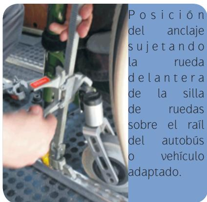
Posición del anclaje sujetando la rueda delantera de la silla de ruedas sobre el raíl del autobús o vehículo adaptado.
